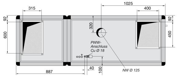
x: Geräte mit Niedertemperatur-Heizregister (NT-PWW) und BWW sind x = 65 mm länger
