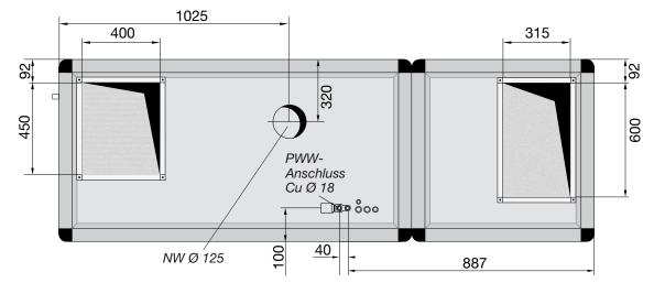
x: Geräte mit Niedertemperatur-Heizregister (NT-PWW) und BWW sind x = 65 mm länger
