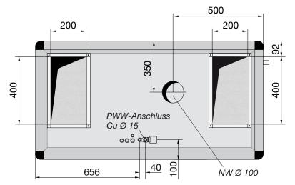
x: Geräte mit Titan-Beckenwasserwärmetauscher sind x=250 mm länger Geräte mit Niedertemperatur-Heizregister (NT-PWW) sind x=65 mm länger
