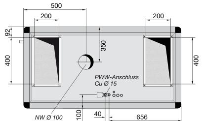
x: Geräte mit Titan-Beckenwasserwärmetauscher sind x = 250 mm länger. Geräte mit Niedertemperatur-Heizregister (NT-PWW) sind x = 65 mm länger.
