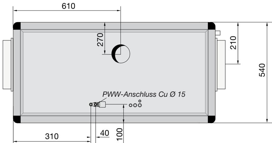
x: Geräte mit Zuluft nach oben sind x = 200 mm länger
