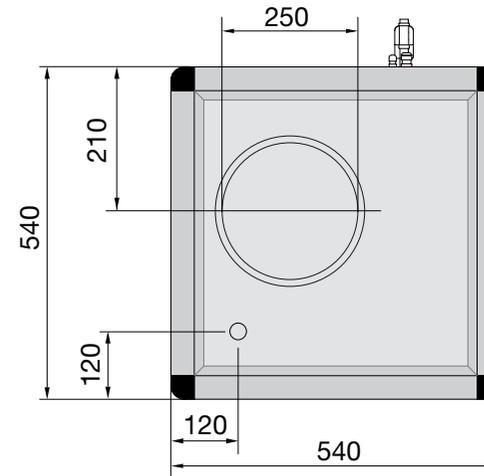
x: Geräte mit Zuluft nach oben sind x = 200 mm länger
